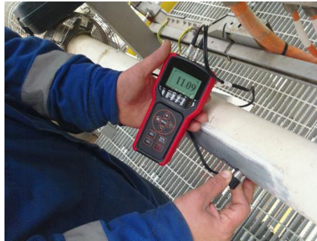
FIGURA 4: DISPOSICIÓN DE TRANSDUCTORES Y MEDICIÓN DE ESPESOR PARA MEDICIÓN DE CAUDAL DE BOMBA SR-P-1312
