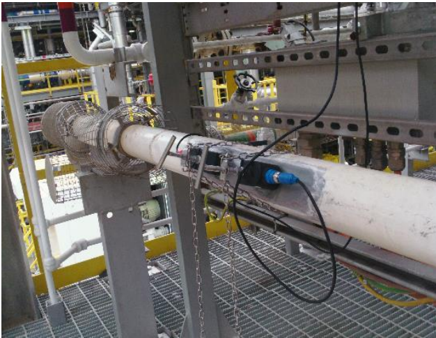
FIGURA 4: DISPOSICIÓN DE TRANSDUCTORES Y MEDICIÓN DE ESPESOR PARA MEDICIÓN DE CAUDAL DE BOMBA SR-P-1312
