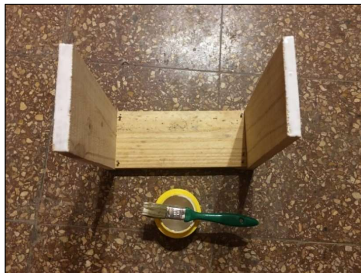
Imagen: Ejecución del molde.
