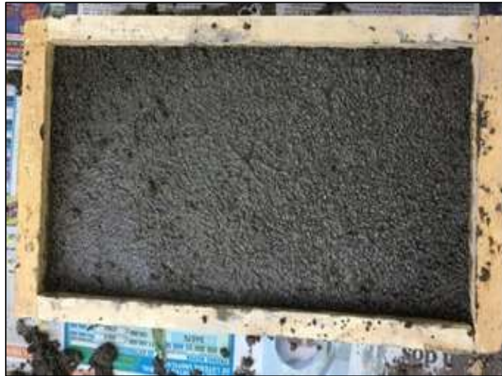
Imagen: Compactación de la mezcla.
