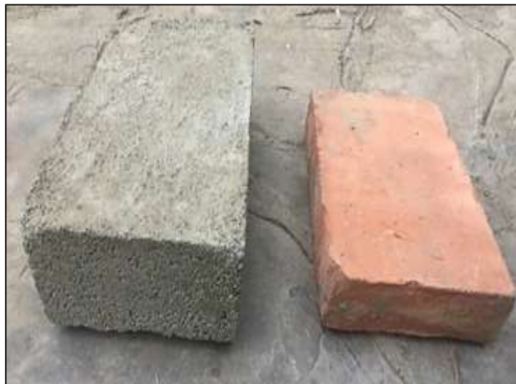
Imagen: Bloque térmico vs ladrillo tradicional de arcilla.
