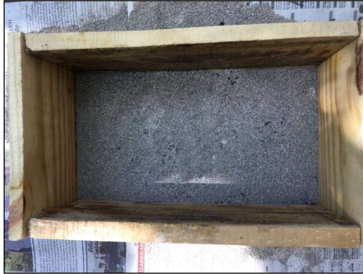
Imagen: Molde con arena en la base.
