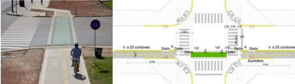
Fig. 26. Cruces verdes / Fig. 27. Esquema de medidas necesarias para los cruces, extraídos de "Anexo V: Lineamientos generales ciclovías y bicisendas", p. 13.
