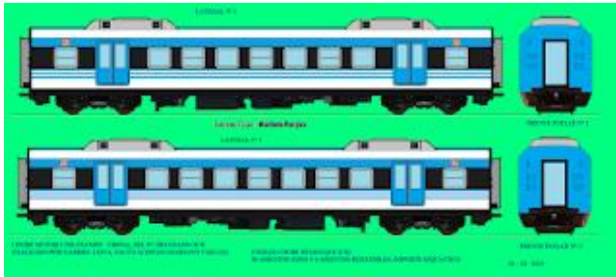
Figura 50.: DMU – CNR – UNIDAD CR. Coche remolcado intermedio sin cabina ni furgón, 50 asientos fijos + 4 asientos rebatibles, TOTAL: 54 asientos. Laterales y frentes idénticos. Imagen realizada por Gabriel Leiva.
