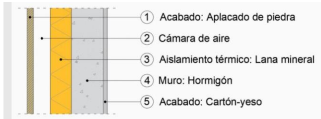
Figura 4 - Cerramiento de vivienda
