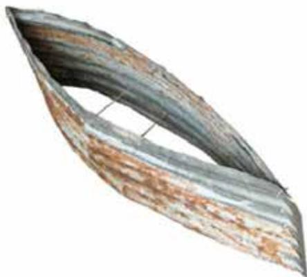
/Prototipo de columna de chapa reciclada. Escala 1en1/
