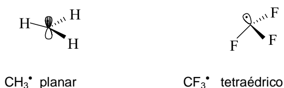
Figura 17. Estructura de los radicales alquílicos y los radicales perfluorados. [5]
