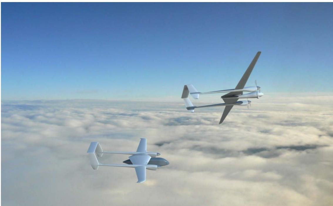
El sistema aéreo no tripulado SARA Clase II de propulsión monomotor a pistón tendría capacidad para embarcar una carga útil de hasta 50 kilogramos, 12 horas de autonomía y hasta 150 kilómetros de alcance; mientras que los SARA Clase III con bimotores turbohélice de desarrollo nacional podrán embarcar una carga útil de hasta 250 kilogramos, 20 horas de autonomía y 1.200 kilómetros de alcance.
