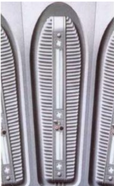
El sistema de refrigeración mecánica tiene las rejillas de salidas en el techo, y a igual que el panel de control, forma parte del revestimiento interior.
