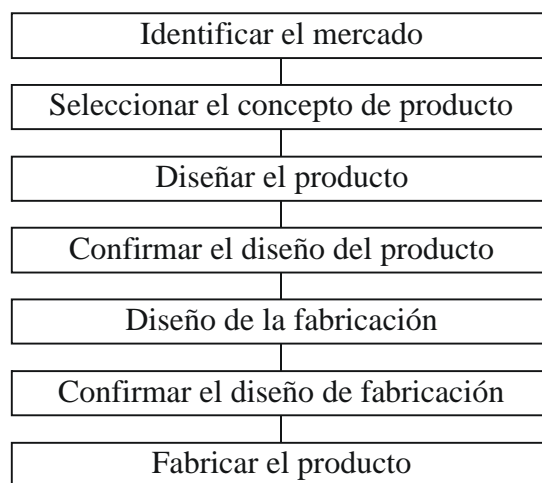
Figura 2.2 - Diagrama de flujo del proceso secuencial (modo tradicional) de diseño desarrollo de nuevos productos [27].
