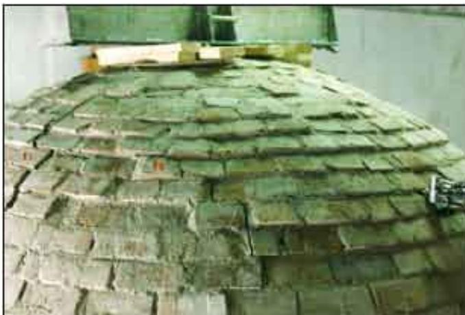
Fig. 96 - El segundo estadio de la fisuración.
