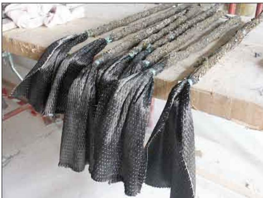
Fig. 93 - Las borlas de anclaje.
