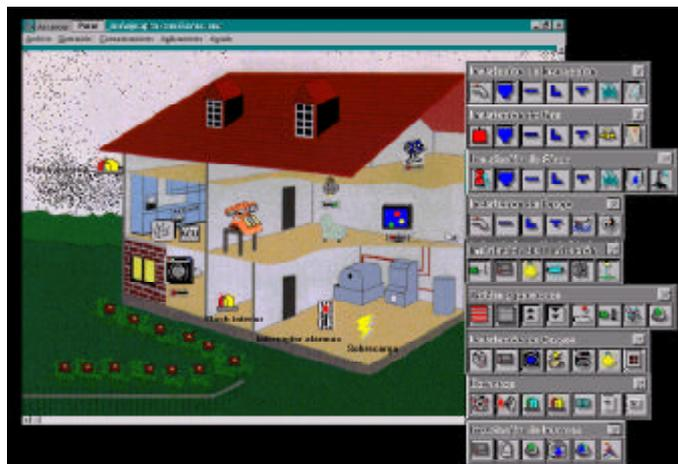
Es una aplicación para entorno Windows que permite diseñar instalaciones domóticas y efectuar la simulación del comportamiento de las mismas en conexión directa con los autómatas programables de las series *SIMATIC S5* y *SIMATIC S7-200* de *SIEMENS*, encargado del control de la instalación dada.
