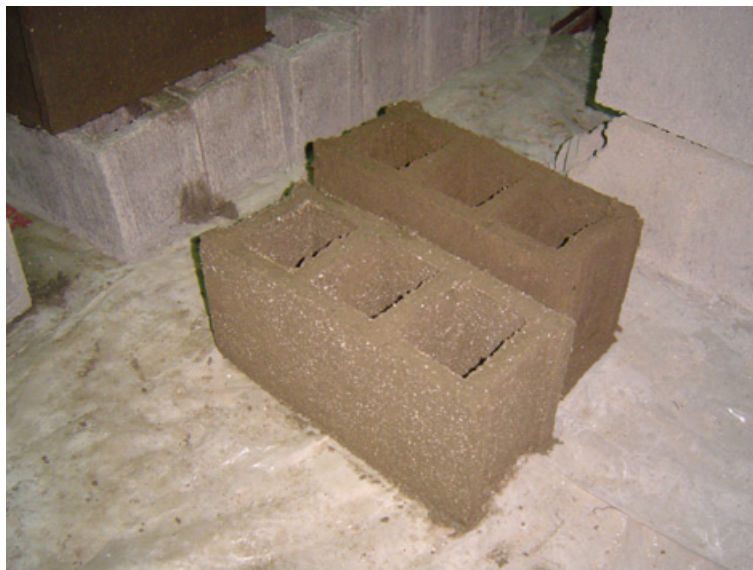
Foto 5.5 Bloques de cemento con telgopor triturado
