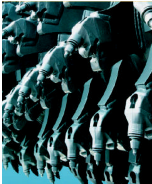
El rotor de fresado y de mezcla con portatrépanos recambiables.
