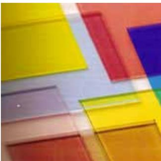
Para evaluar mejor la elección del tipo de vidrio en una obra, es necesario tener en cuenta el coeficiente de sombra. Este mide la cantidad de energía que permite pasar a un ambiente un vidrio. Se toma como referencia que un vidrio incoloro transparente de 3mm de espesor tiene un coeficiente de sombra equivalente a 1. Existen diversas maneras de bajar este coeficiente, de reducir la ganancia térmica y los altos costos de acondicionamiento climático.
